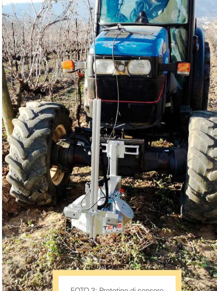
FOTO 3: Prototipo di sensore MECS-WOOD per valutazioni della vigoria mediante rilievo sui tralci in assenza di vegetazione
