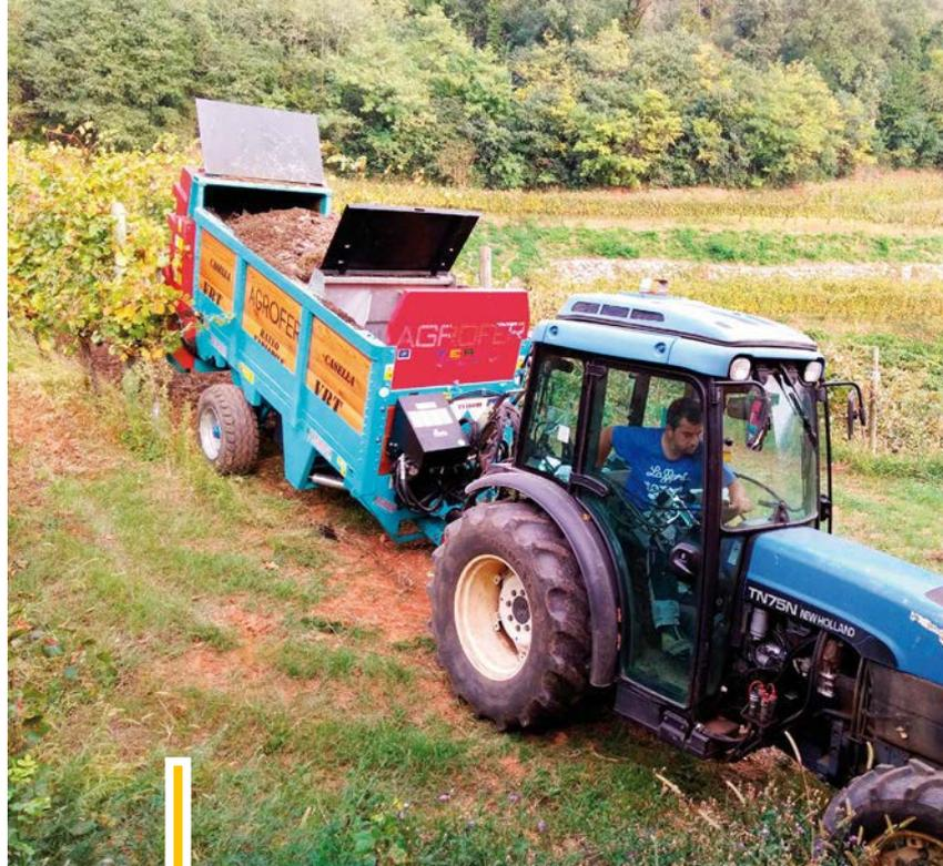
FOTO 1: PROTOTIPO AUTOLIVELLANTE PER VIGNETI TERRAZZATI E IN PENDENZA
