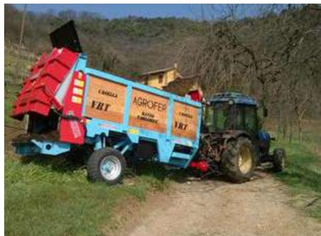
vellamento del cassone e di un impianto idraulico di frenatura servocomandato dal trattore, aumentando la maneggevolezza e la sicurezza di utilizzo del carro all'interno di appezzamenti terrazzati o caratterizzati da contropendenze importanti (foto 3).
