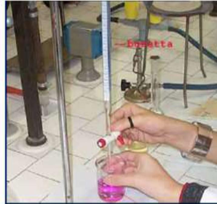
Titolazione dell'NaOH residua con HCl
