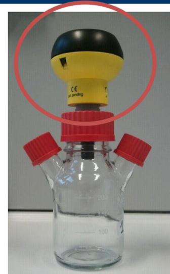
Misura della variazione della pressione interna mediante il trasduttore di pressione *OxiTop<sup>®</sup>-C Measuring Head*
