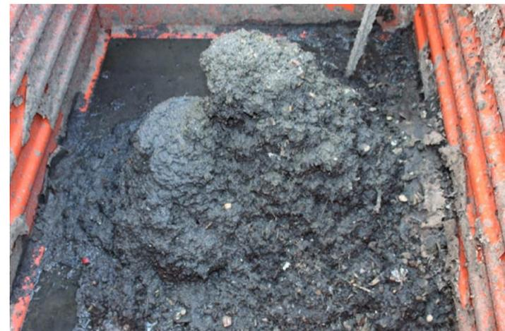
Possibilità di dosare l'acqua in ingresso per la corretta omogeneizzazione della matrice da inviare alla fase di digestione anaerobica
