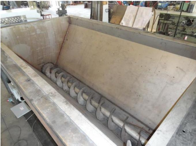
La componente plastica, più leggera, tende a salire nella parte alta del biotrituratore dove viene collettata ed evacuata da una còclea orizzontale. La componente organica e gli inerti più pesanti vengono triturati e mischiati con acqua per creare una purea che scende al fondo del biotrituratore.
