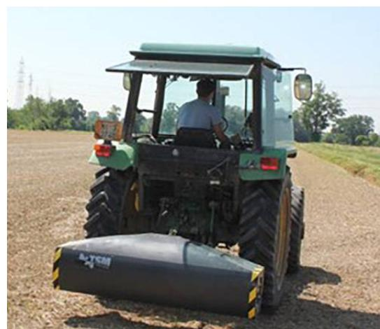
**Fig. 1 – Operazioni di scansione del suolo nei campi studio utilizzando un sensore elettromagnetico Tsm**
