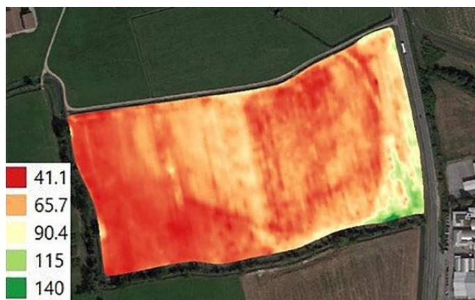
**Fig. 5 – Mappa di variabilità della conducibilità elettrica (espressa in ms) in un appezzamento preso come caso-studio.**
